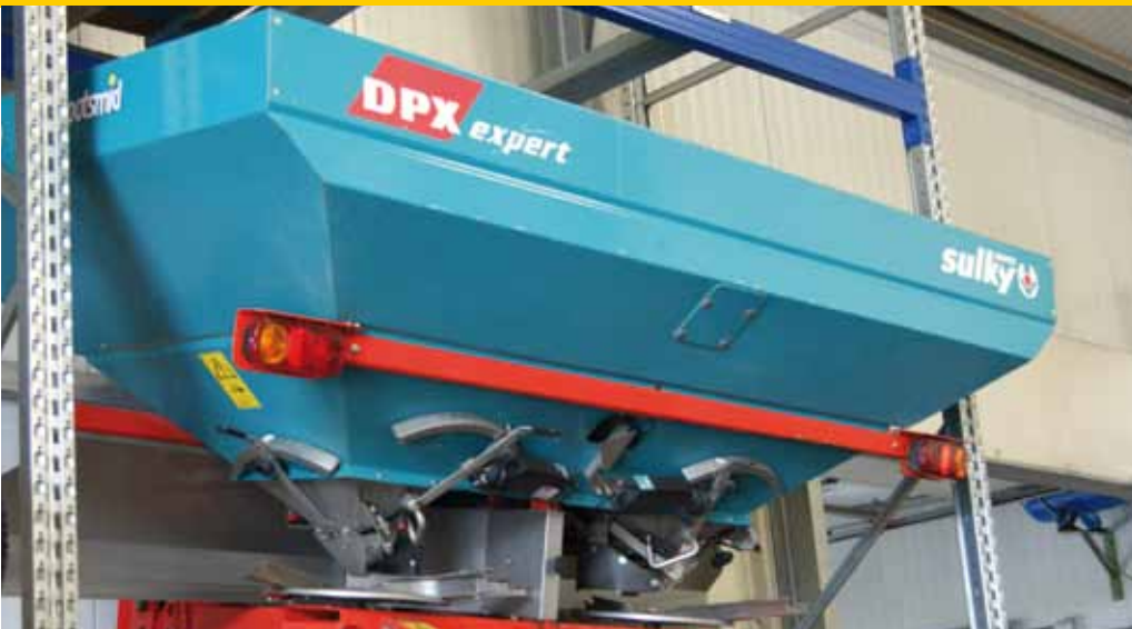
In de plaats van de oude mechanische strooier heeft Antens vorig jaar een computergestuurde strooier met weeginstallatie aangeschaft.
